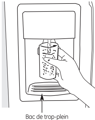
Bac de trop-plein
