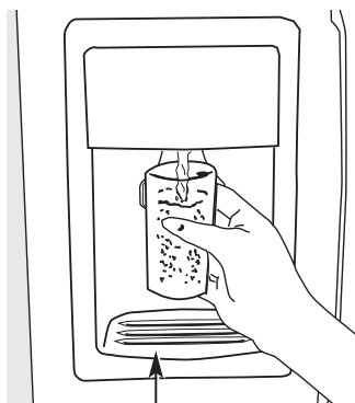
Bac de trop-plein
