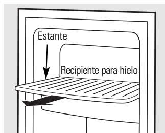
Para alcanzar el interruptor eléctrico.
