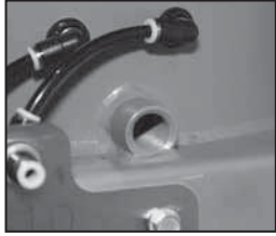
Fan Drain Connection
