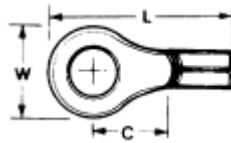
Figure 36. DC Power Terminal Lug
