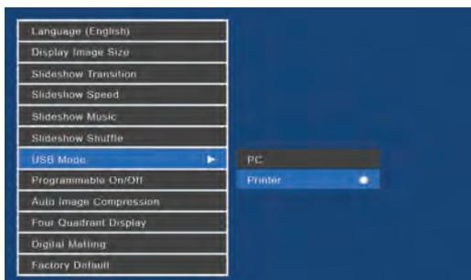
Connectez le Cadre Photo Numérique HP à votre imprimante photo PictBridge™ en utilisant le câble USB fourni avec l'appareil. Un message apparaîtra sur l'écran pour indiquer que la connexion de l'imprimante a été détectée.
