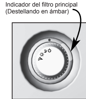
Fig. 3 - Indicadores del Pre-filtro y del Filtro principal, con cubierta superior
